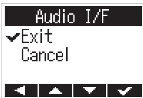
Dadurch wird der Betrieb als Audio-Interface beendet und der Aufnahme-Screen wieder geöffnet.
