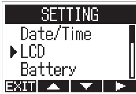
2. Wählen Sie mit <sup>LOCUT</sup>  und <sup>LIMITER</sup>  den Eintrag „Contrast“ und drücken Sie <sup>AUTOLEVEL</sup> .
