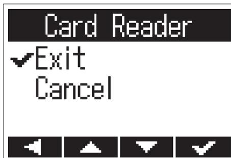
Dadurch wird der Betrieb als Kartenleser beendet und der Aufnahme-Screen wieder geöffnet.
